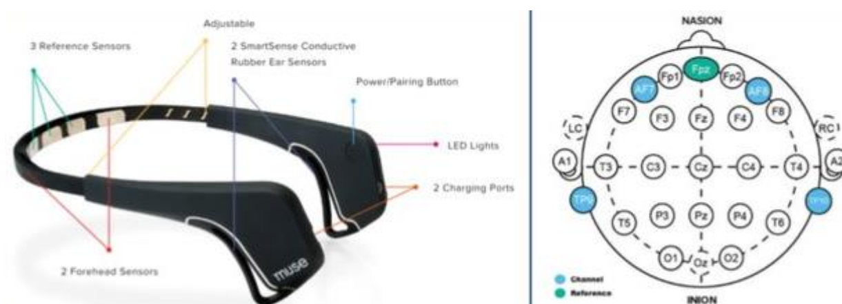
รูปที่ 2 แถบบันทึกสัญญาณคลื่นไฟฟ้าสมองยี่ห้อ MUSE ตำแหน่งที่บันทึก ได้แก่ AF7 AF8 TP9 TP10 และตำแหน่งอ้างอิง Fpz ดัดแปลงจาก (KONSTANTINOS TSIAKAS, 2018)
